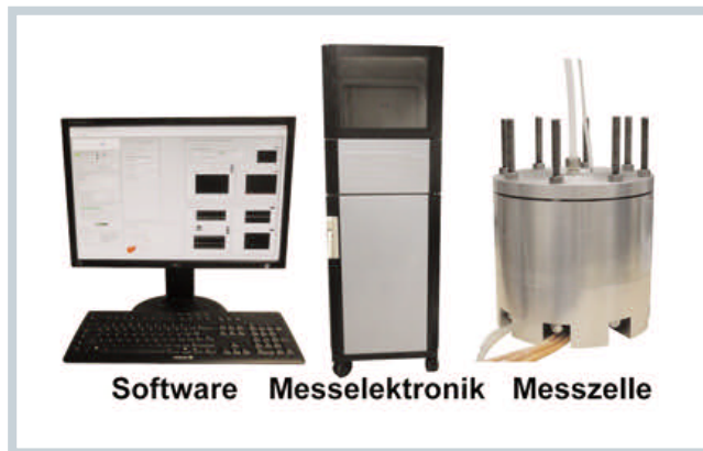
Bild 4. Mit dem neu entwickelten Messsystems (links) kann das hydrodynamische Tränkungsverhalten realitätsnah nachgebildet werden. Das rechte Bild zeigt die Kavität und die Sensoren ohne Messzelle
