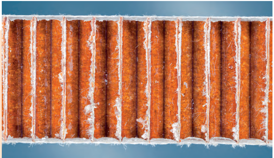
Querschnitt einer Sandwichplatte Cross section of a sandwich panel
