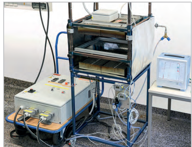
Entwickeltes IR-Strahlerfeld zur optimierten Erwärmung der additivierten NF-Proben im Labormaßstab
