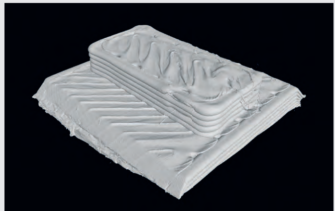
Röntgentomographische ( \mu CT) Aufnahme einer additiv gefertigten Polyamid 12-Probe für tribologische Untersuchungen; Abmessungen 4 \times 8 \times 1,5 \text{ mm}^3
