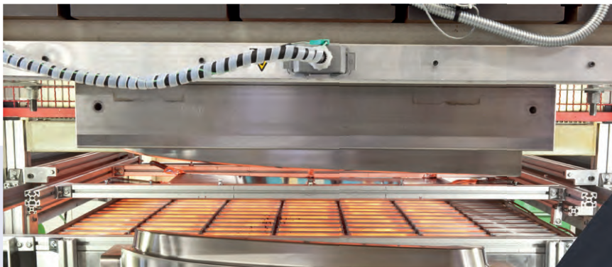
Presse mit IR-Strahlerfeld
